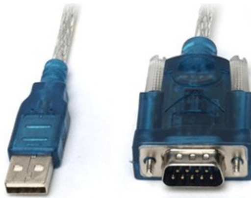
Rysunek 26. Porównanie RS232 z USB
